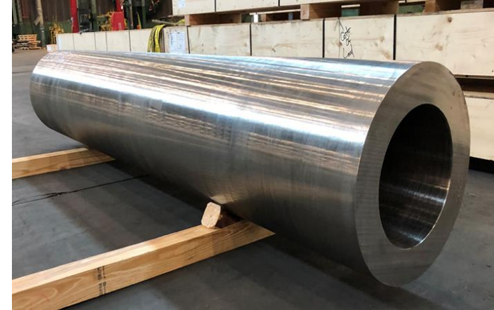
22" OD x 3.7" W pipe extruded at Wyman-Gordon
