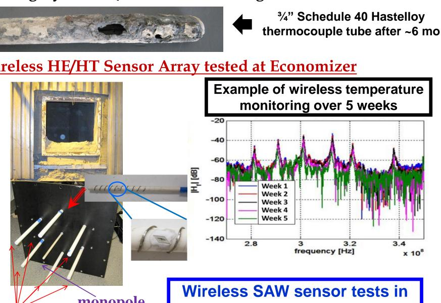
mònopole **6 dipoles + interrogating** SAW Sensors antenna
