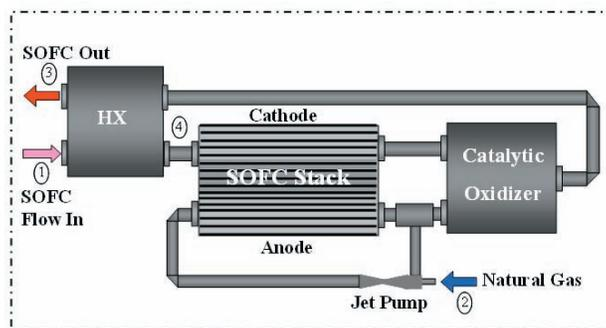
Fig. 17. SOFC module
