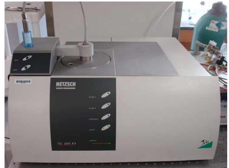
Thermogravimetric analyzer (Netzsch TGA 209 F1 Iris)
