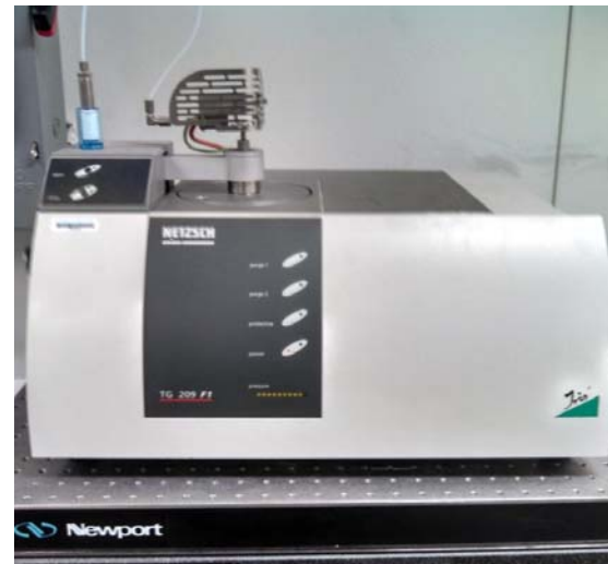
Thermogravimetric analyzer (Netzsch TGA 209 F1 Iris)
